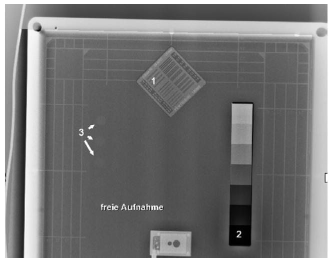
Abb. 3: Röntgenbild eines Testphantoms gem. ÖNORM S 5240-8 und S 5241: Kontrast, Auflösung und Signal-zu-Rausch-Verhältnis werden mithilfe von Linienpaaren (1), Grauwerteskala (2) und Loch-Schablone (3) standardisiert gemessen. Die Strahlenmengenverteilung ist, wie das Bild verdeutlicht, nicht gleichmäßig.
