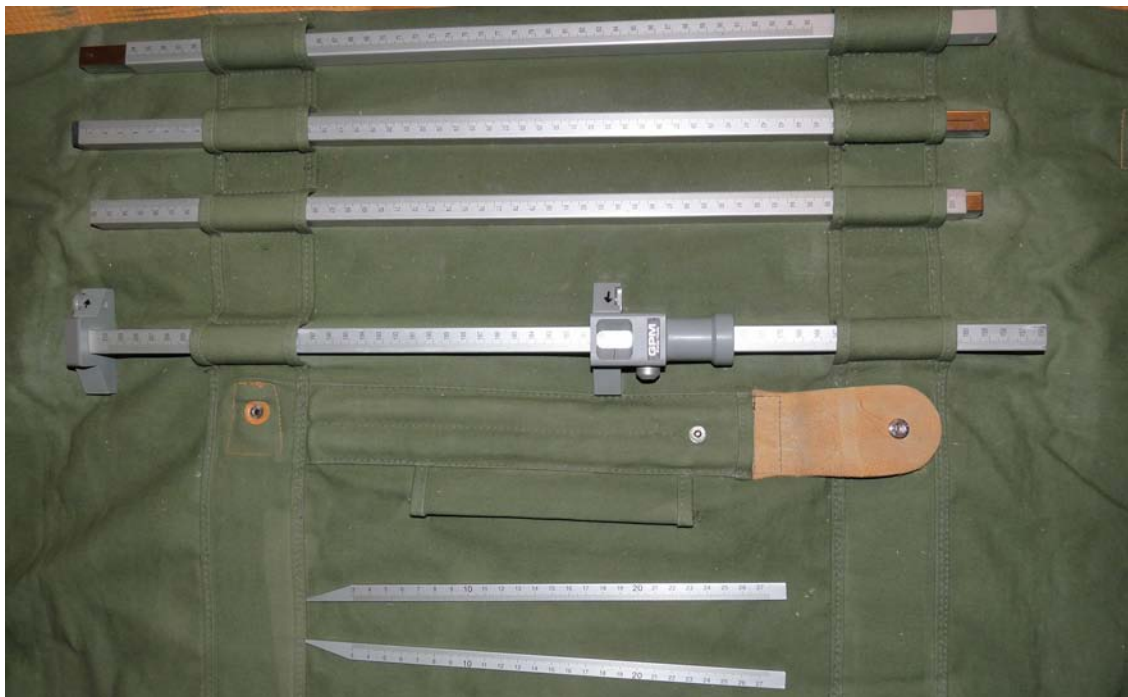
Abb. 1: Schublehre mit einer Maximallänge von zwei Metern:
