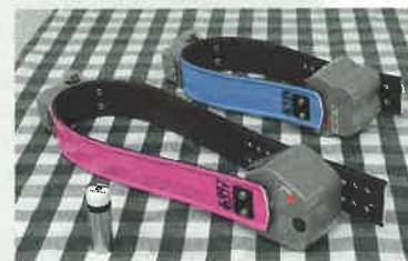
Abb. 5: GPS-Halsbandsystem, bestehend aus je einem Senderhalsband und einer Pansensonde („Schlucksonde“).
