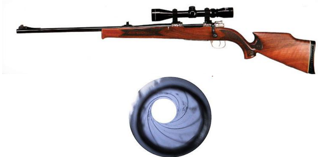
Abb. 4 Eine typische Jagdbüchse. Das untere Bild zeigt die Riffelung im Inneren des Laufs, die nach dem Abfeuern individuelle Spuren auf den Kugeln hinterlässt (Quelle: Wikimedia Commons)
