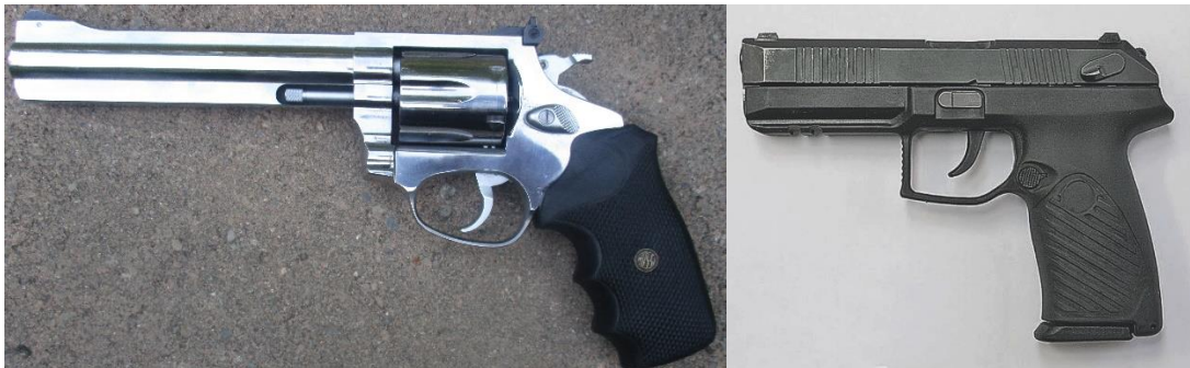
Abb. 3 Die zwei Typen von Handfeuerwaffen: Revolver (links) und Pistole (rechts) (Quelle: Wikimedia Commons).
