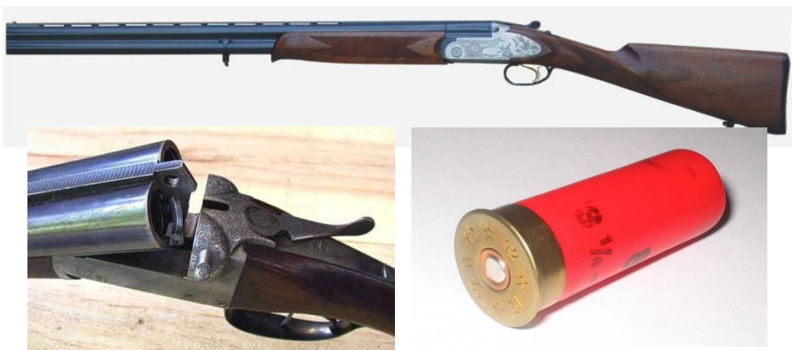
Abb. 5 Eine typische Schrotflinte für Jagdzwecke mit zwei übereinander (oben) und nebeneinander (unten) montierten Läufen und der entsprechenden Munition (Quelle: Wikimedia Commons).
