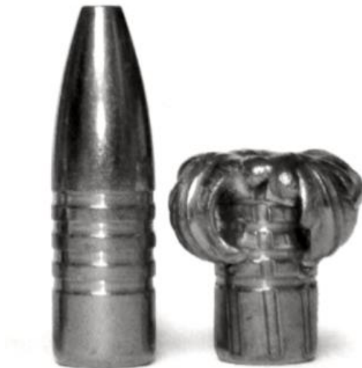
Abb. 8 Die Form eines deformierenden Geschosses vor (links) und nach dem Auftreffen auf einen Körper (rechts). Die typische "Pilzform" gewährleistet eine hohe Energieübertragung im Körper (Quelle: Wikimedia Commons)
