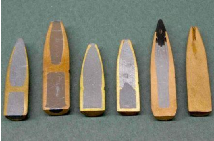
Abb. 7 Querschnitte einiger Geschosse die für Jagd Zwecke verwendet werden, mit Darstellung der verschiedenen Ausführungen hinsichtlich Material, Form und Ummantelung (Quelle: Wikimedia Commons).
