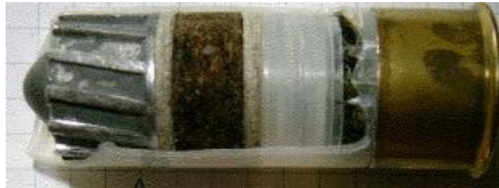
Abb. 11 Querschnitt einer Flintenhülse mit einem Flintenlaufgeschoss (links) (Quelle: Wikimedia Commons).
