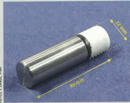
Abb. 1: Zur Messung der inneren Körpertemperatur und Pulsrate von Rotwild kamen solche „Schlucksonden“ zum Einsatz.
