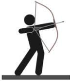
Abb. 2.14 Beim Bogenschießen wird die Sehne gespannt und dabei der Bogen elastisch verformt. Lässt man die Sehne los, so beschleunigt die Spannkraft des Bogens den Pfeil.
