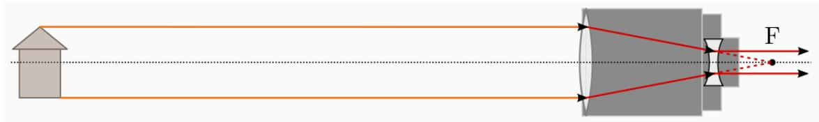
Abb. 3.32 Strahlengang in einem Galilei-Fernrohr.
