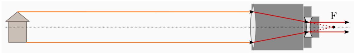
Abb. 3.32 Strahlengang in einem Galilei-Fernrohr.
