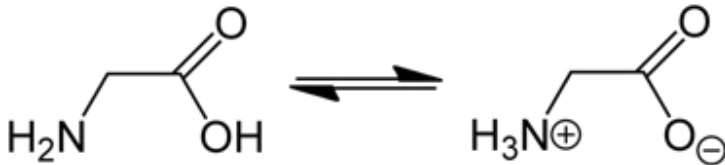
Abb. 9.17: Bildung des Zwitterions am Beispiel der Aminosäure Glycin bei neutralem pH-Wert
