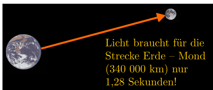
Abb. 3.2 Ein von der Erde ausgesandter Lichtstrahl erreicht den Mond rund eine Sekunde später.
