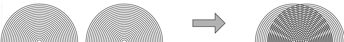
Abb. 2.78 Interferenz zweier kreisförmiger Wellen.
