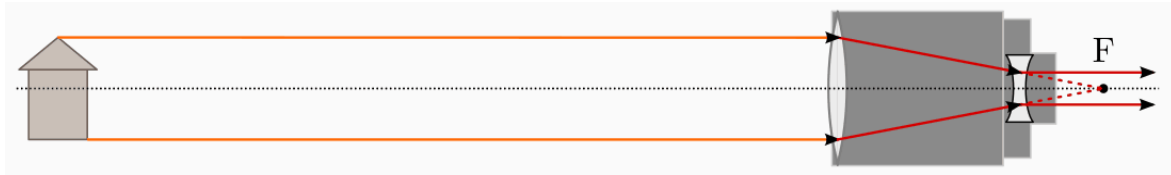
Abb. 3.32 Strahlengang in einem Galilei-Fernrohr.
