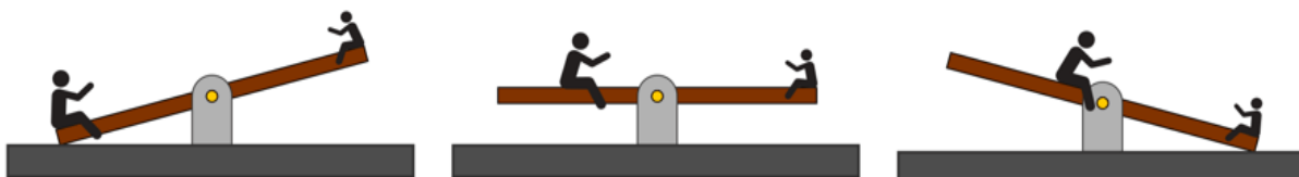
Abb. 2.34 Die Wippe als (zweiseitiger) Hebel: Nicht nur die wirkende Kraft, auch der Abstand zur Drehachse ist von Bedeutung.
