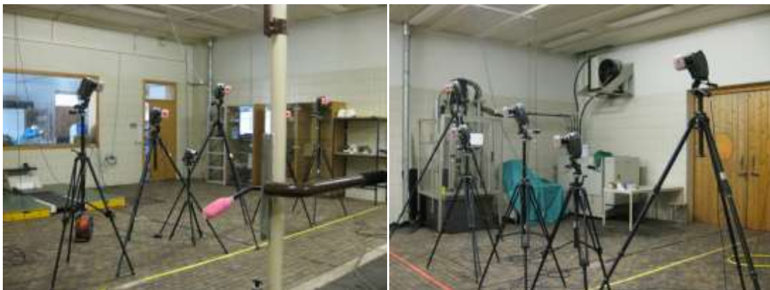
Abbildung 39 (links): Kameraanordnung in der Bewegungsanalytikhalle der VUW, rechts der Laufrichtung des Laufbands.
